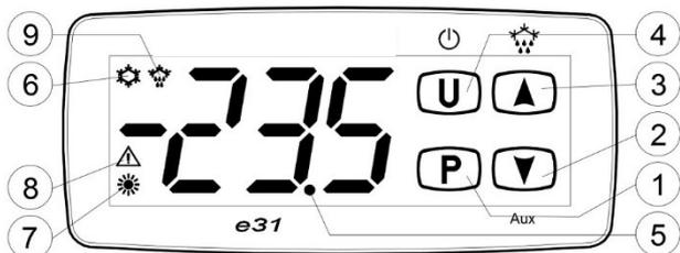
**1 - Tecla P:** Usada para configurar o SET POINT (pressione e solte) e para acessar os parâmetros de programação (mantenha pressionada por 5 segundos).
